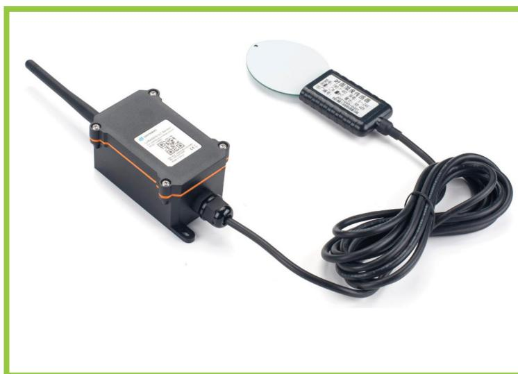
Questo sensore impermeabile LoRaWAN per l'IoT dell'agricoltura misura l'umidità e la temperatura delle foglie. L'agricoltore potrà, così, analizzarne lo stato studiando, ad esempio, l'idratazione o la quantità di rugiada e gelo presenti sulla superficie fogliare.
