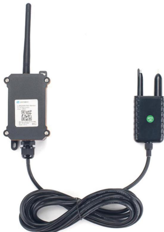
È un sensore impermeabile LoRaWAN per l'IoT progettato per misurare e monitorare il PH e la temperatura del suolo. Lo scopo è quello di analizzarne i dati in relazione ad acidità e alcalinità.
